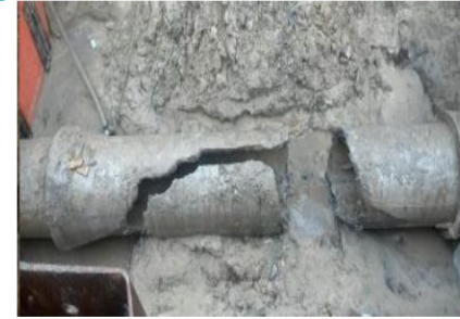
4. fotó: SENTAB vezeték meghibásodása, 2019, XV. Pázmány P. u., DN700 (1985)
