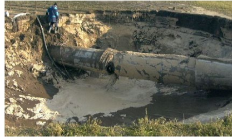
2. fotó: SENTAB vezeték meghibásodása, 2005, XXIII. Vecsés út, DN1000 (1985)
