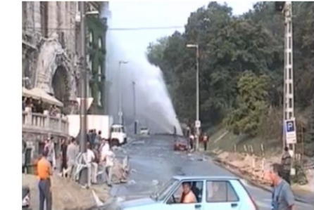
5. fotó: Öntöttvas vezeték csőtörés, 2002, XI. Kelenhegyi út, DN800 (1981)
