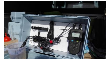
HQ40d multiparaméteres mérőműszer
