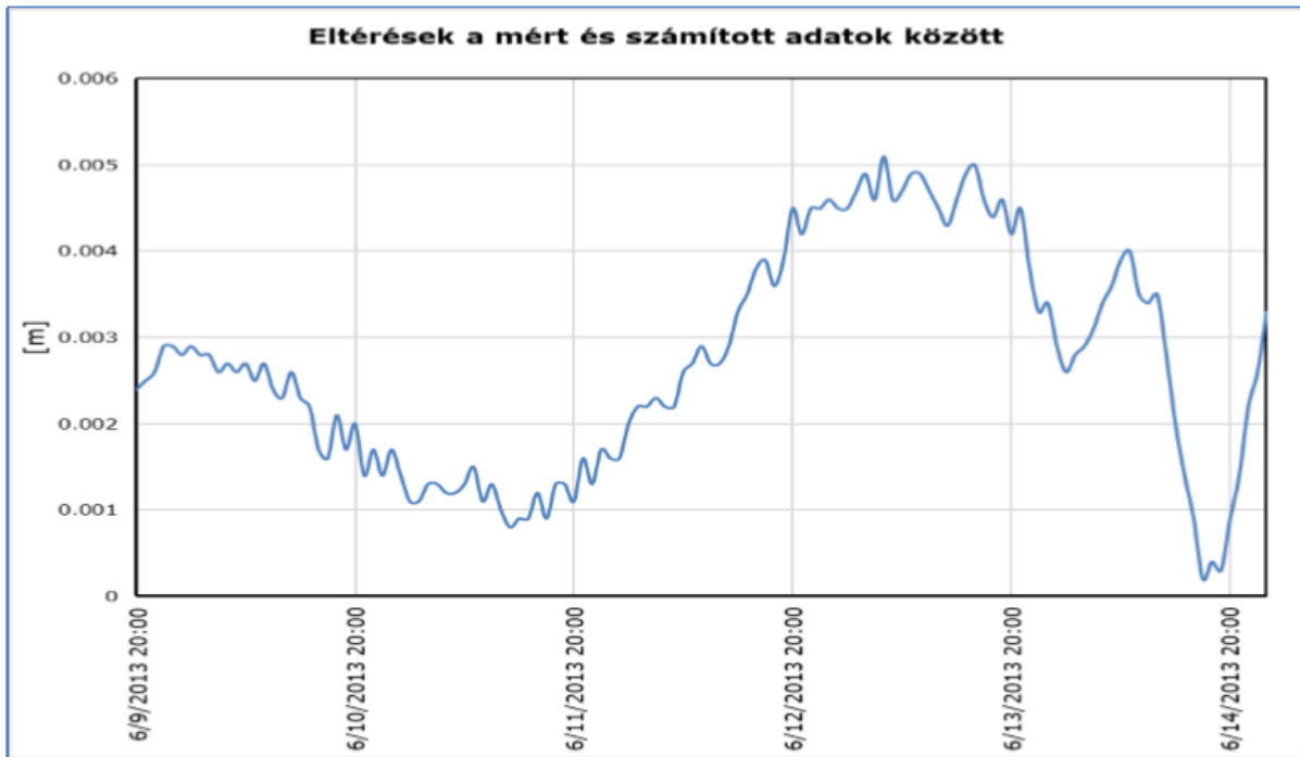
6. ábra: Az 1D modell kalibrációja: eltérések a mért és számított adatok között a futás időtartományában
