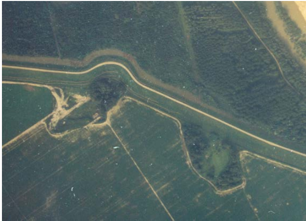
1. kép Szigetközi kopolyáknál a helyreállítás. A bal oldali kopolya az 1899. évi gátszakadás helye.
