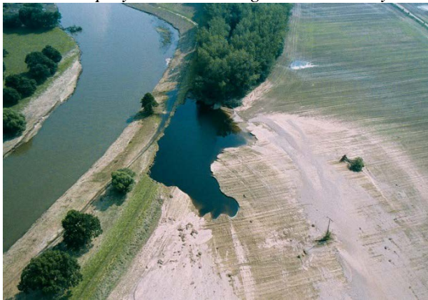
3. kép Mulde folyó (Szászország) mellett kialakult kopolya alakja 2002. évi árvíz
