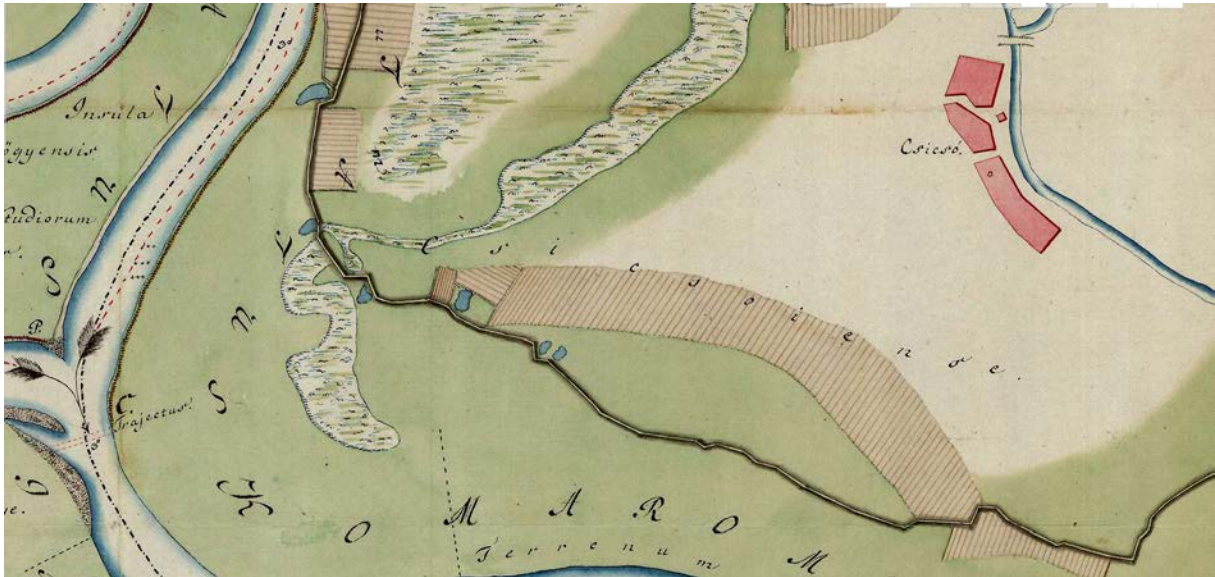
1. ábra Csicsótól nyugatra lévő hat kopolya. Úgy tűnik, hogy egy a holtmeder kereszteződésnél van. Három kopolyánál a mentett oldalon, háromnál a vízoldalon állították helyre a gátat.
