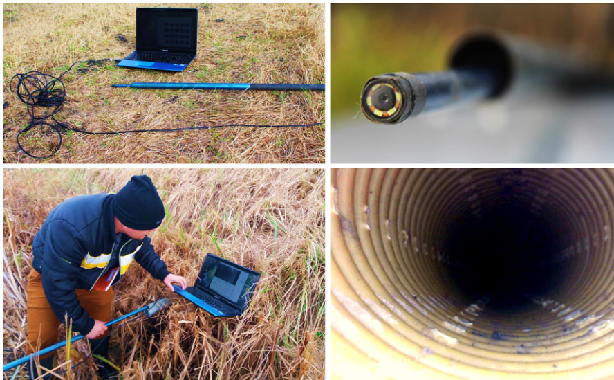
3. ábra. A hordozható számítógépre csatlakoztatható csőkamera használat közben, valamint egy a kamerával készült kép a vizsgált dréncső belsejéről
