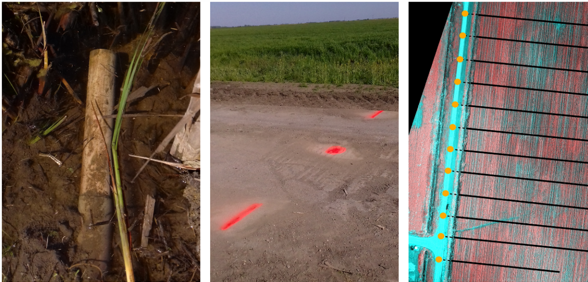
2. ábra. A feltárt dréncső helyzetének terepen történő megjelölése később a dréncső pontos helyzetének meghatározását segíti elő az általunk elkészített légi felvételen.
