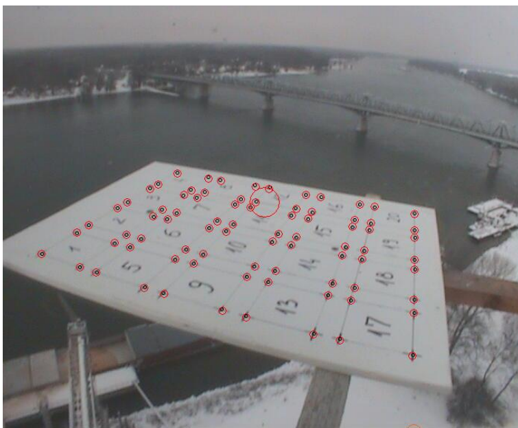
4. ábra: Bajai régi webkamera síklapos kalibrálásának ellenőrzése
