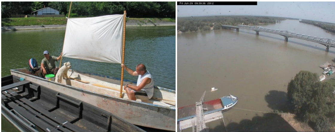
5. ábra: Csónakos mérés kifeszített ponyvája, első oszlopon a GPS vevőfejével, Váits Zoltánnal és Forrás nevű pumival (Fotó: Farkas Zoltán). Jobbra a webkamera képe látható a mozgó csónakkal a ponyvával.
