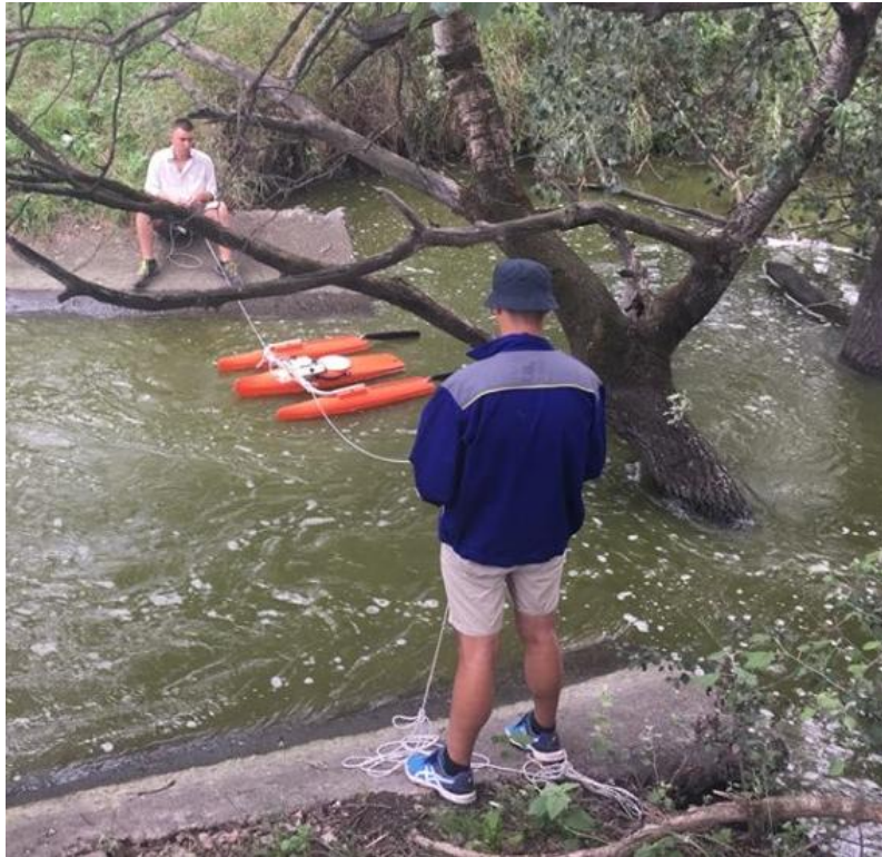
18. ábra Vízhozammérés ADCP-vel a Ludasi tó kifolyásánál
