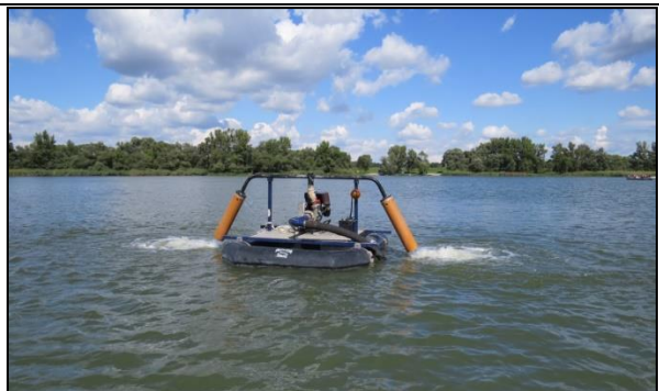
8. kép: Robbanómotoros vízugaras levegőztető egység
