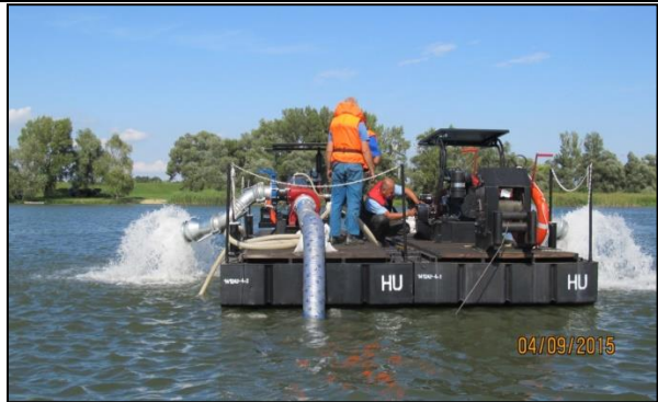
4. kép: A levegőztető berendezés működés közben
