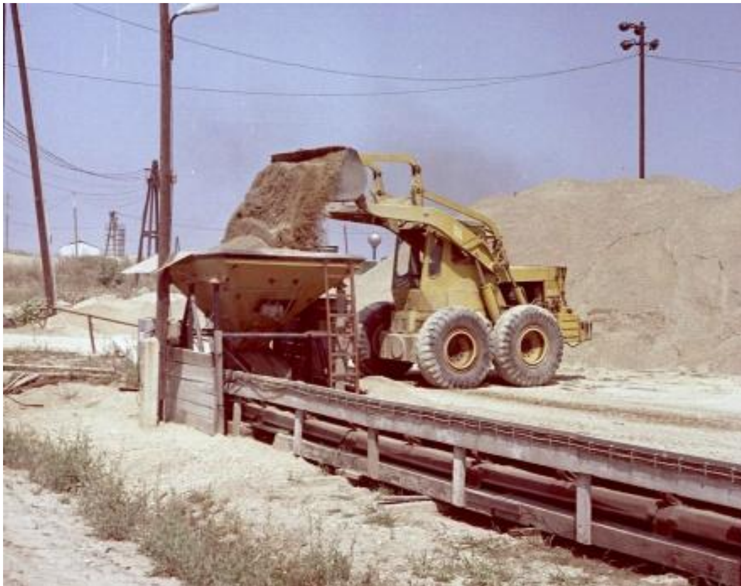
Az adalékanyagot 1 m 3 -es Tigä rakodógép rakta a központi szállítószalagra
